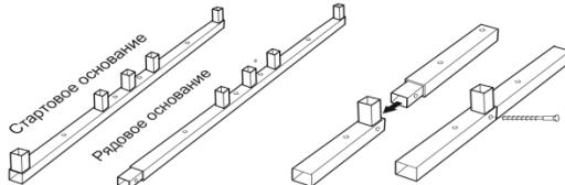
Закрепите собранное основание с помощью саморезов по краю фундамента, предварительно просверлив отверстия.
