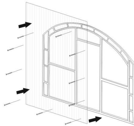
Расположите торцы на листе поликарбоната как указано на схеме раскроя, предварительно сняв обе защитные пленки.
