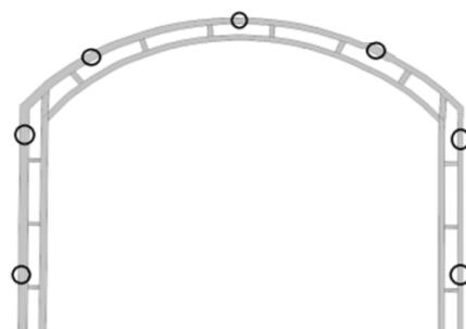
Вариант 1. Крепеж верхних направляющих с помощью винтов и гаек с внутренней стороны
