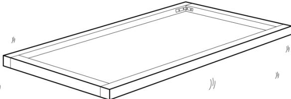
В случае использования в качестве фундамента деревянного бруса, необходимо окопать фундамент землей для предотвращения переворачивания или смещения теплицы под действием сильного ветра.
