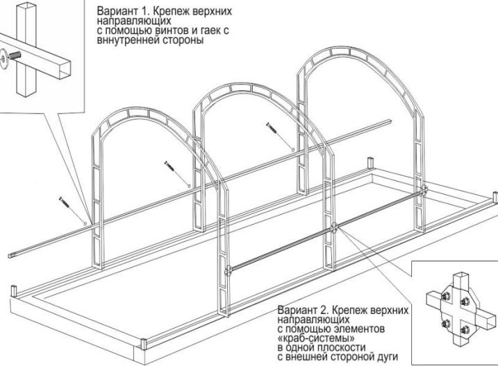
Вариант 2. Крепеж верхних направляющих с помощью элементов «краб-системы» в одной плоскости, с внешней стороной дуги
