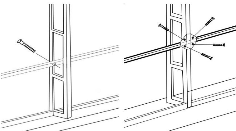
Установите конек и зафиксируйте его саморезами ПШС.
