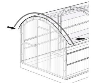
Концы стяжных лент рекомендуется подогнуть под поликарбонат на кровле. Уложенный материал закрепить кровельными саморезами по образующей поверхности дуги. Затем прорезать проем форточки и двери и прорезать поликарбонат на петлях, чтобы он не мешал открыванию и закрыванию двери и форточки. Ручки для дверей необходимо закрепить при помощи саморезов ПШС, либо болтами, предварительно просверлив отверстия.
