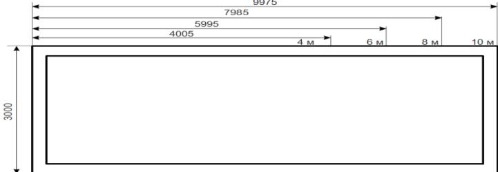
Выберите участок для установки теплицы и выровняйте поверхность так, чтобы высота неровностей была не более 5 см. Установите фундамент для теплицы (из бруса 100x100 мм или ленточный бетонный)
