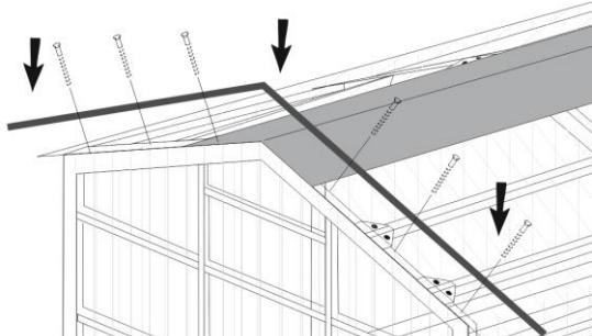
Концы стяжных лент рекомендуется подогнуть под поликарбонат на кровле. Уложенный материал закрепить кровельными саморезами по образующей поверхности дуги.
