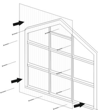
Положить торец на ровную поверхность так чтобы форточка и дверь открывались вверх. Приложить лист поликарбоната к торцу строго определенной стороной листа вверх (если такая сторона указана на схеме раскроя поликарбоната) так, как показано на схеме раскроя поликарбоната. Для облегчения монтажа поликарбоната на торец, можно предварительно просверлить отверстия в металле сверлом 3 мм, либо прокрутить торец кровельными саморезами без поликарбоната.
