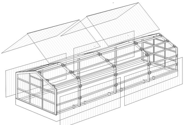
Установите конек и зафиксируйте его саморезами ПШС.
