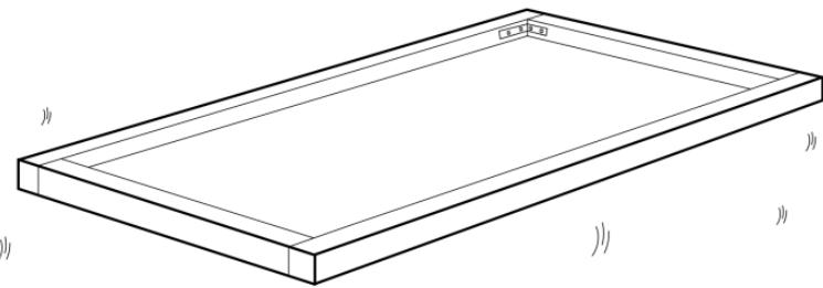
**ВНИМАНИЕ!** Фундамент должен быть ровным по горизонтали. В случае использования в качестве фундамента деревянного бруса, необходимо окопать фундамент землей для предотвращения переворачивания или смещения теплицы под действием сильного ветра.
