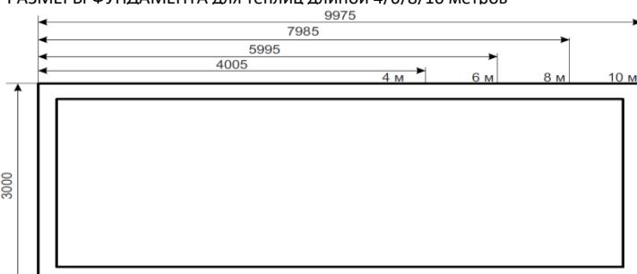
Выберите участок для установки теплицы и выровняйте поверхность так, чтобы высота неровностей была не более 5 см. Установите фундамент для теплицы (из бруса 100x100 мм или ленточный бетонный)
