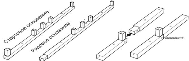
Закрепите собранное основание с помощью саморезов по краю фундамента, предварительно просверлив отверстия.
