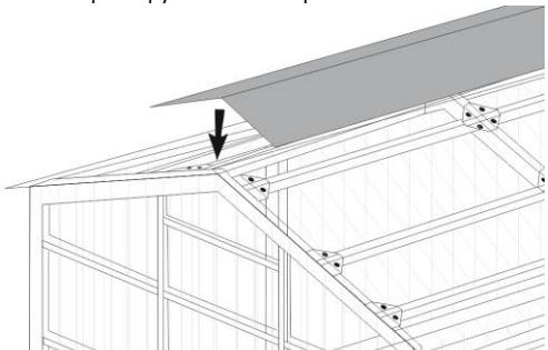
Действия по установке лент аналогично действиям по монтажу поликарбоната с той разницей, что крепление поликарбоната саморезом, осуществляется через оцинкованную ленту, этот передовой способ крепления, обеспечивает большую устойчивость к ветрам, предотвращает прорыв поликарбоната, и удерживает листы поликарбоната по всей дуге теплицы.
