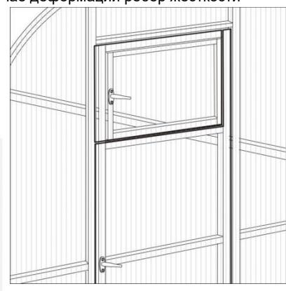
Строительным, либо обычным острым ножом обрезать выступающие части поликарбоната за арочную часть, затем прорезать проем форточки и двери и прорезать поликарбонат на петлях, чтобы он не мешал открыванию и закрыванию двери и форточки.
