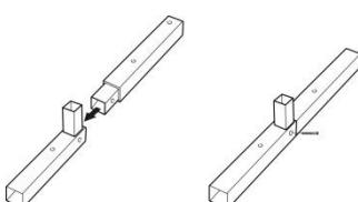
3 Зафиксируйте основания между собой с помощью саморезов.
