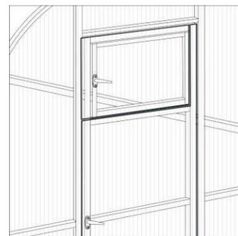
Строительным, либо обычным острым ножом обрезать выступающие части поликарбоната за арочную часть, затем прорезать проем форточки и двери и прорезать поликарбонат на петлях, чтобы он не мешал открыванию и закрыванию двери и форточки. Ручки для дверей необходимо закрепить при помощи саморезов ПШС, либо болтами, предварительно просверлив отверстия.
