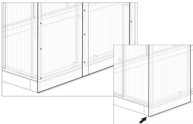
**ВНИМАНИЕ!** При креплении поликарбоната к каркасу, необходимо соблюдать направление крепления. Например, крепить поликарбонат по дуге, слева направо, слегка натягивая и проглаживая его для предотвращения образования пузырей между дугой и поликарбонатом. Крепить поликарбонат сначала у основания дуг с двух сторон, а потом сверху **НЕПРАВИЛЬНО**.
